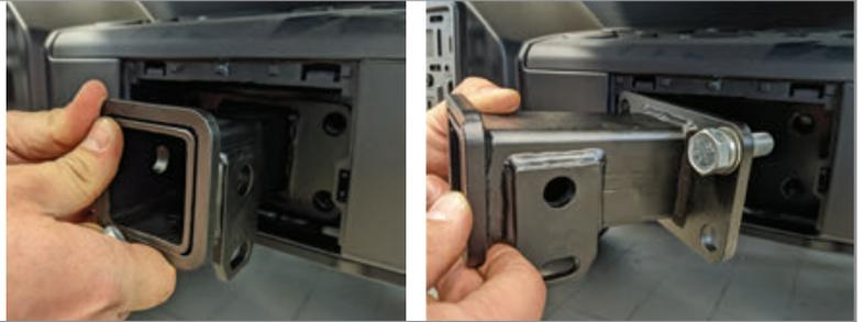
**ШАГ 3.** Отрегулируйте положение балки ТСУ относительно задней поперечины рамы и затяните все соединения.
